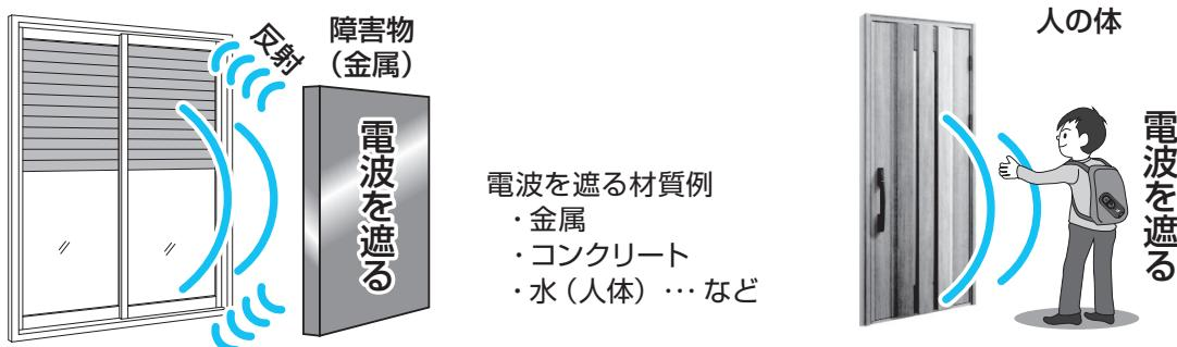
※ 特に金属は電波を反射しやすく、電波を遮断します。
