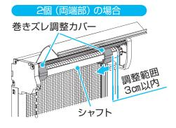
※図はボトムバーの左側が片下がっている場合の調整を示しています。
