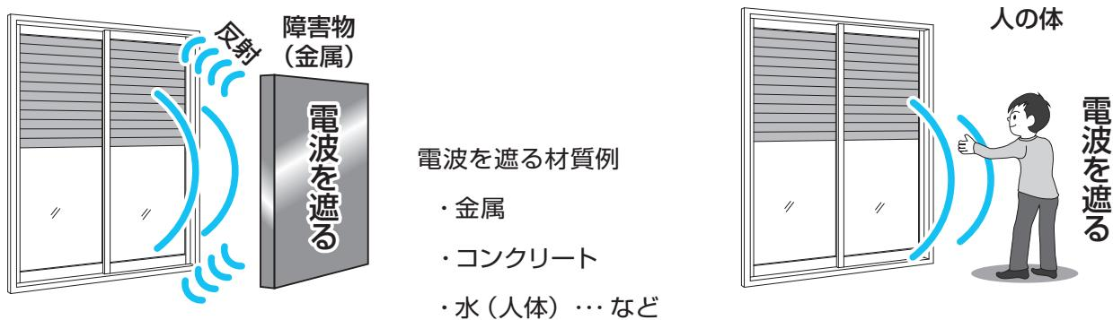
※ 特に金属は電波を反射しやすく、電波を遮断します。
