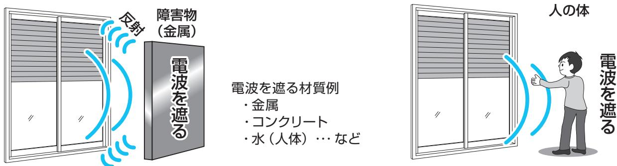
※ 特に金属は電波を反射しやすく、電波を遮断します。
