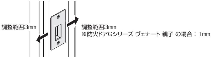
**3** 調整後、上下錠が錠受けへ確実におさまっているか確認し、必ずネジをしっかりとめ付けてください。
